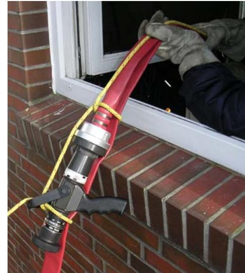
Abb. 5: „amerikanisches“ Einbinden mit Hohlstrahlrohr
