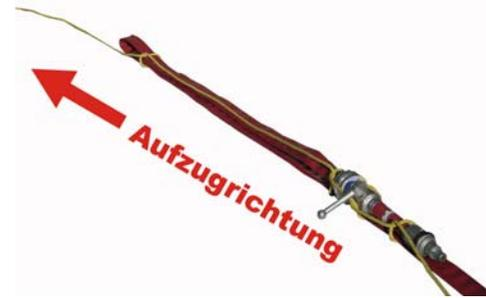
Abb. 6: „amerikanisches“ Einbinden mit CMM-Rohr
