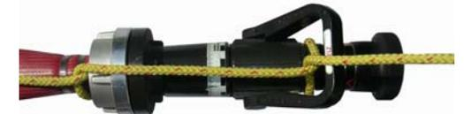
Abb. 7: Einbinden von Hohlstrahlrohren (1)
