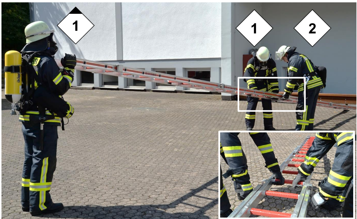
Abbildung 6: Zusammenstecken der Steckleiterteile
