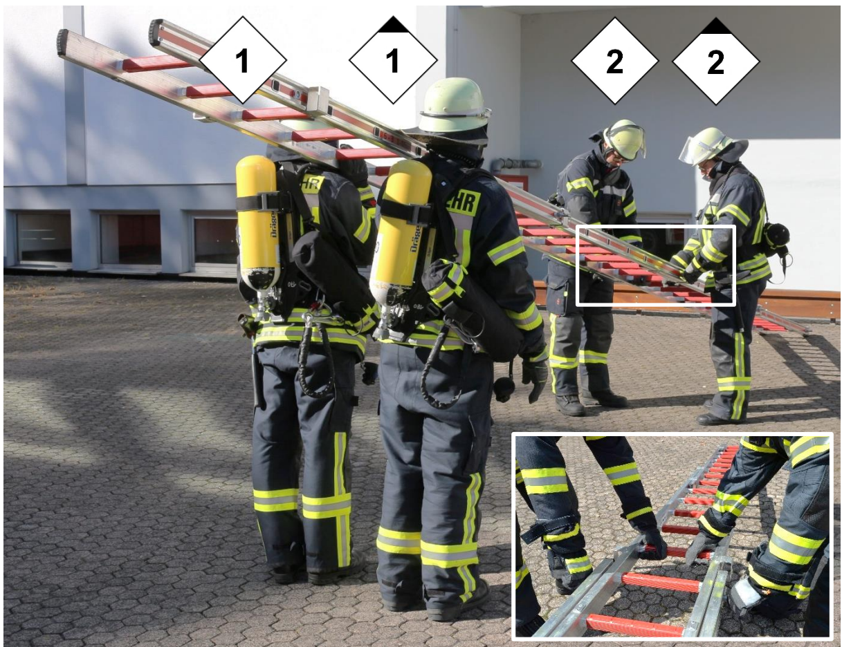
Abbildung 11: Zusammenstecken der Steckleiterteile
